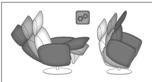
Synchrone Verstellung der Beinauflage und Rückenlehne durch Elektro-Motor ohne Relaxposition, inklusive Aufstehhilfe (max. 120 kg.) Mit fixierbarer Drehfunktion.
