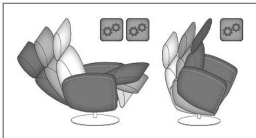
Individuelle Verstellung der Beinauflage und Rückenlehne durch zwei Elektro-Motoren und einem zusätzlichen Elektro-Motor für die Aufstehhilfe (max. 120 kg).
