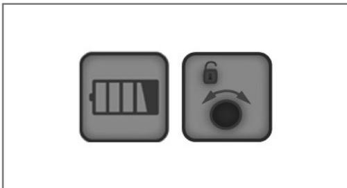
Außenliegender Wechsel-Akku. Außen aufsteckbar und daher auch nachbestellbar. Akku wird inkl. USB-Ladekabel geliefert. USB-Ladeadapter nicht im Lieferumfang enthalten. Nur für die Baureihe mit passender Aufnahmebuchse einsetzbar! Nur lieferbar mit den Funktionen F und FH (100 Verstellungen), E, G3 und G3H (65 Verstellungen)
