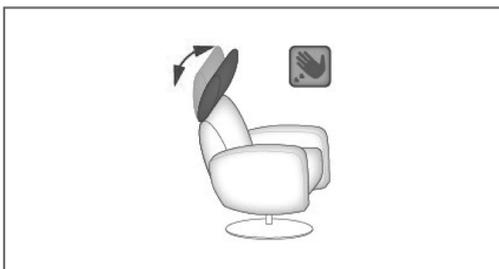
Alle Ausführungen sind generell mit einer manuellen Kopfpolsterverstellung über einen Rastbeschlag mit Rückholfeder ausgestattet.
