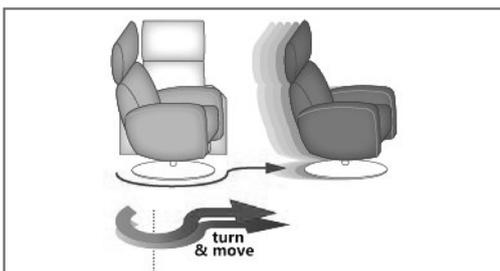
Durch integrierte Rollen im Drehteller lässt sich der Sessel einfach verschieben. Die Funktion darf nur zum Schieben des Sessels genutzt werden. Rollen müssen zum Sitzen immer eingefahren werden. Bitte zusätzlich den Sessel beim Verschieben vom Stromkreis lösen. Nur bei den linsenförmigen Drehtellern Metall V6 und Holz AD3 möglich. Mit der patentierten Funktion.
