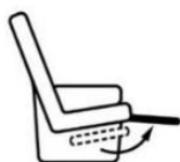
Ausschwenkbares Fußteil manuell verstellbar
