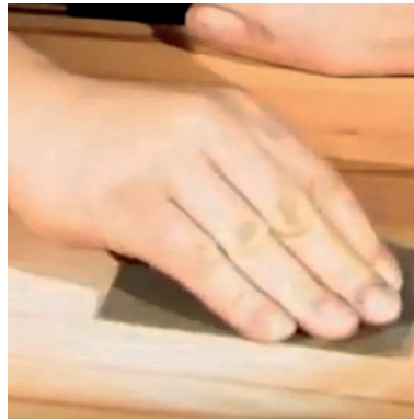
in Faserrichtung ausschleifen
