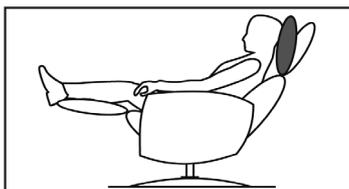
Generell mit manueller Kopfteilverstellung ausgestattet. Der Rast-Klemmbeschlag lässt sich einseitig rasten und individuell in jeder Position über eine Klemmtechnik zurückführen.
