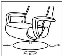
Schieben einfach gemacht. Durch integrierte Rollen im Drehteller lässt sich der Drehsessel einfach verschieben. Funktion darf nur zum Schieben des Sessels genutzt werden. Rollen müssen zum Sitzen immer eingefahren werden. Bitte zusätzlich den Sessel beim Verschieben vom Stromkreis lösen.
