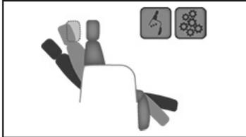
Individuelle Verstellung der Beinauflage und Rückenlehne durch zwei Elektro-Motoren und einem Elektro-Motor für die Aufstehhilfe (max. 120 kg) inkl. Herz-Waage-Position. Mit fixierbarer Drehfunktion.
