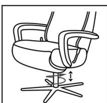
Mittels der höhenverstellbaren Drehspindel lassen sich die Ergonomie Größen small, medium und large in der Sitzhöhe von 44 bis 49 cm variabel einstellen.
