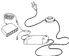
Elektronisches Vorschaltgerät (EVG) mit Fußschalter und mit Fußschalter und Verteiler für maximal 7 Beleuchtungselemente
