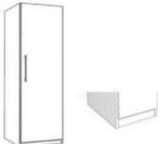
Front gekürzt (auf Wunsch) Sockel sichtbar 62mm Bodenfreiheit
