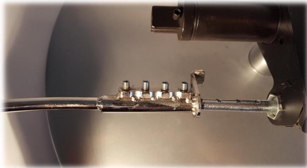
**Verriegelungshebel** auf die Spannwelle schieben so dass die Bohrungen mit den 4 x M6 Gewindebohrungen
