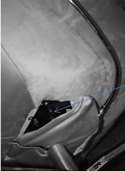
Die Wippfunktion kann mittels Einstellschraube justiert werden.
