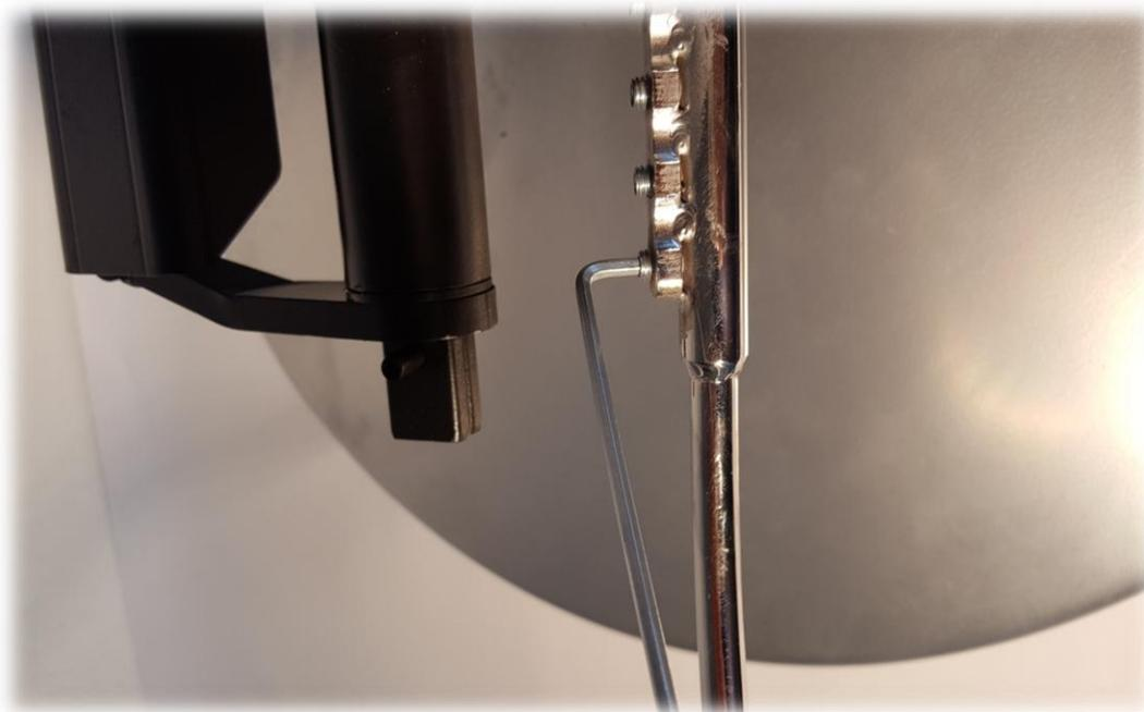
Das 0,5mm Feinblech zwischen Klemmblech und Bremsbelag stecken und die Klemmschraube mit der Spannmutter leichtl verspannen dass das Feinblech nicht hinunter fällt.
