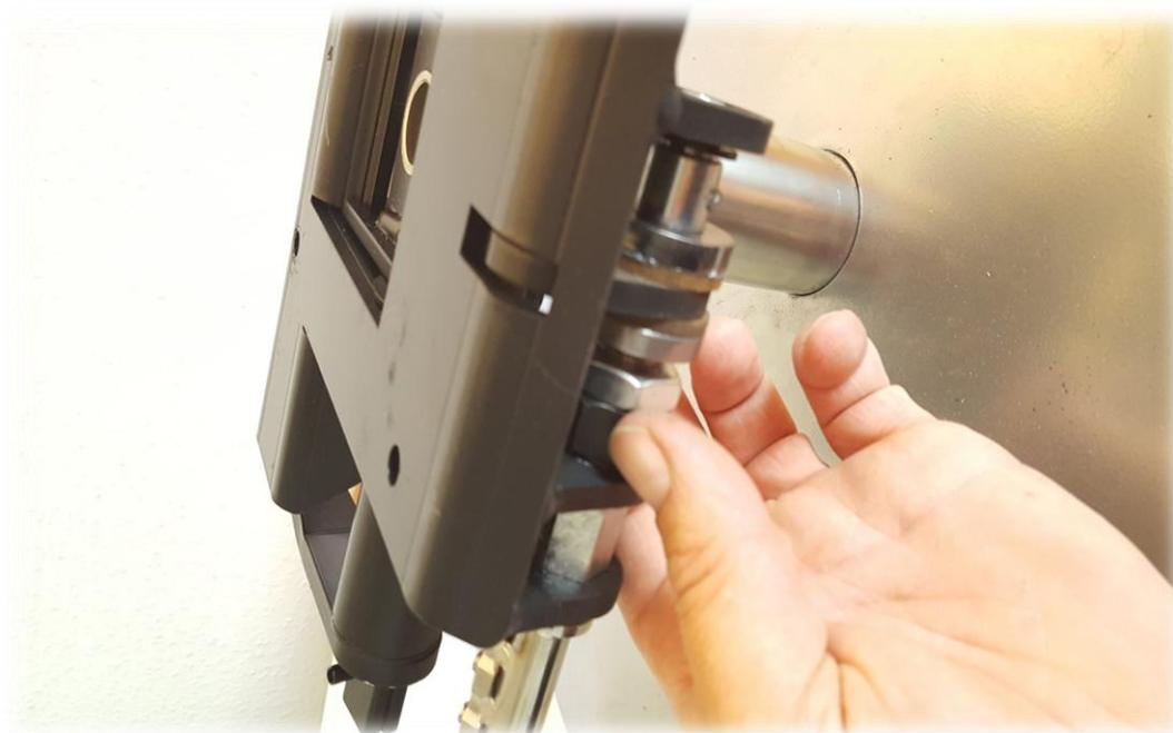
Bei der Wippe mit dem montierten Verriegelungshebel kann jetzt der Sitzrahmen aufgeschraubt werden.
